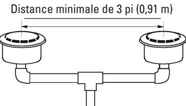
**Chaque couvercle de sortie de vidange à aspiration aura une capacité égale ou supérieure au débit maximal du système.**
