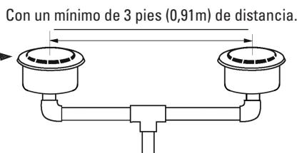
**La clasificación de cada cubierta de salida de succión debe equivaler al caudal máximo del sistema o superarlo.**
